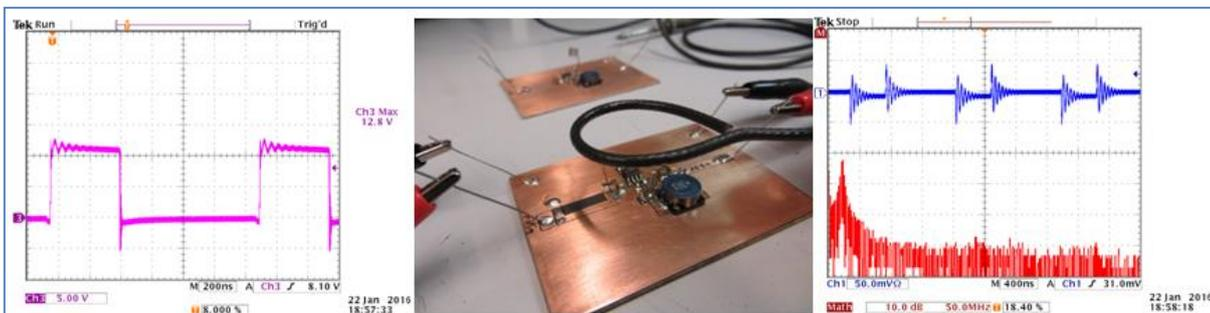
圖 23：在 IC 的 GND 和 VIN 之間增加一隻 0603 10nF 電容
