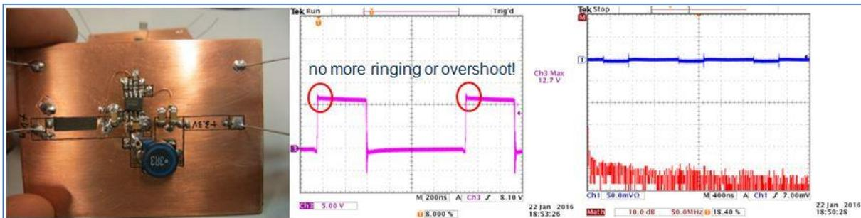
圖 25：使用最短化 C<sub>IN</sub> 回路的最後方案
